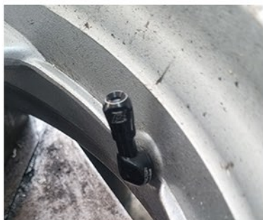
Figura 5 : Bico 90 graus Procton instalado
