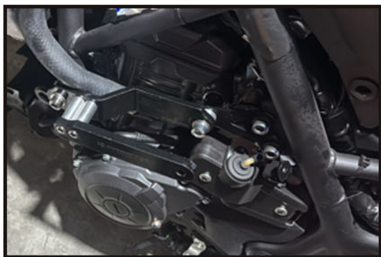
Foto 1: Foto do Slider Esquerdo instalado
