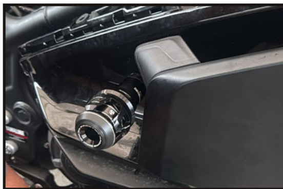
Foto 2: Foto do Slider Direito instalado
