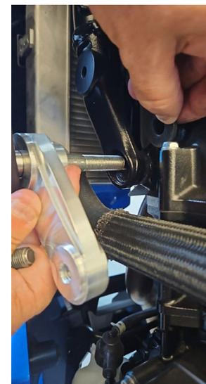
Foto 5: Instalando o slider lado esquerdo junto com a bucha original
