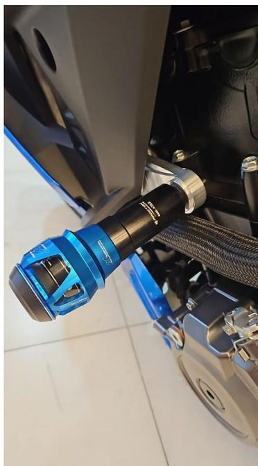
Foto 6: Suporte instalado com parafuso e bucha de assentamento
