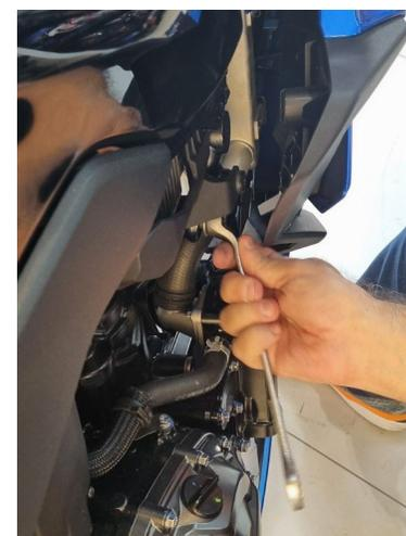
Foto 1: Retire os parafusos originais
