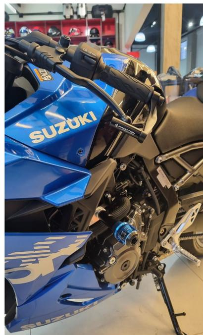
Foto 7: Slider Procton GSX-8R lado dir. instalado
