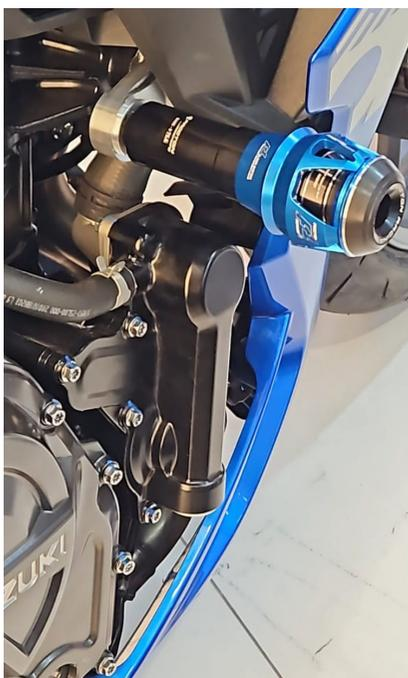
Foto 3: Slider com a base e cabeça de impacto instalados
