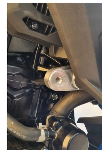
Foto 2: Suporte do lado dir. Instalado e carenagem recolocada
