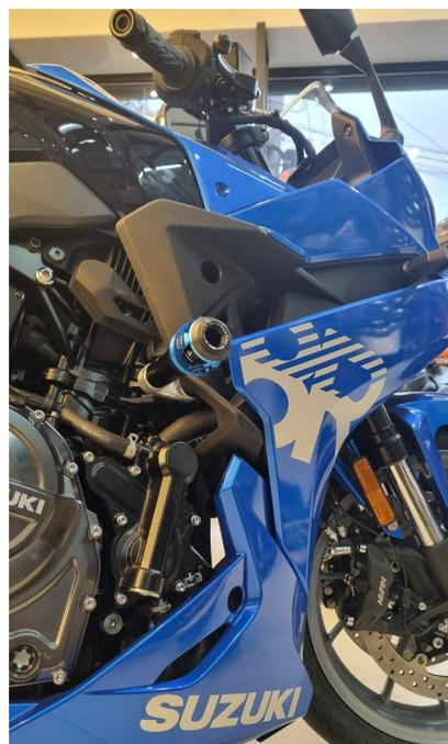
Foto 4: Slider Procton GSX-8R lado dir. instalado
