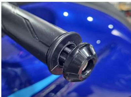
**Figura 1:** Use uma chave Philips ou Allen para remover o peso original.
