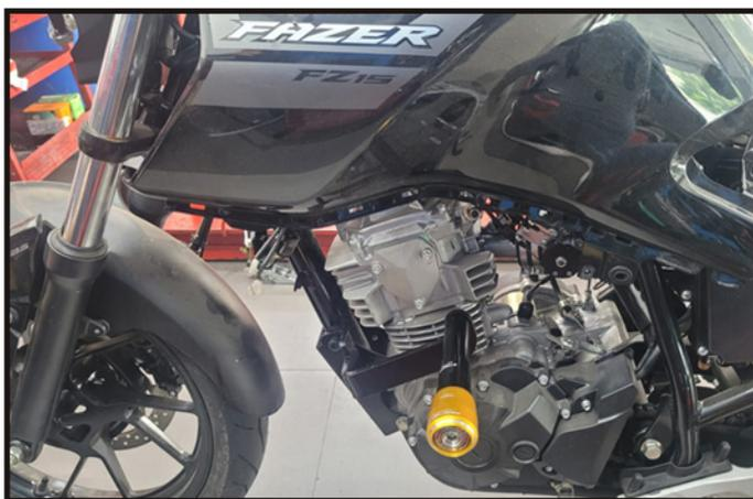
Foto 1: Foto do Slider Esquerdo instalado
