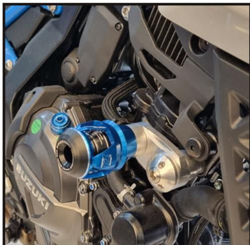
**Foto 01: Slider instalado no Lado Direito**
