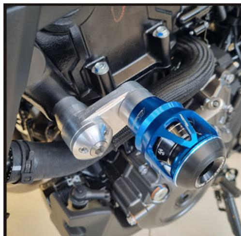
**Foto 02: Slider instalado no Lado Esquerdo**
