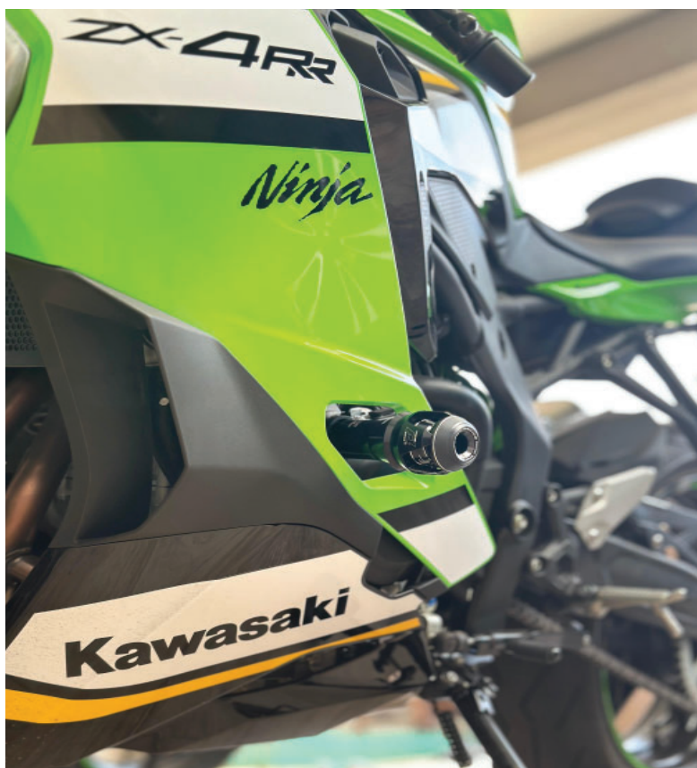
Foto 6: Slider ZX4 RR lado Esquerdo já instalado
