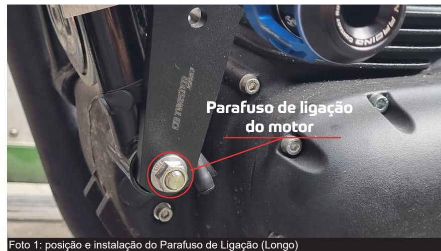
Foto 1: posição e instalação do Parafuso de Ligação (Longo)
