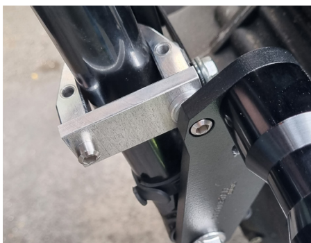
Foto 02: Slider instalado no Lado Esquerdo
