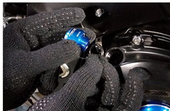
Figura 2: Instale o oring original na tampa de óleo da Procton
