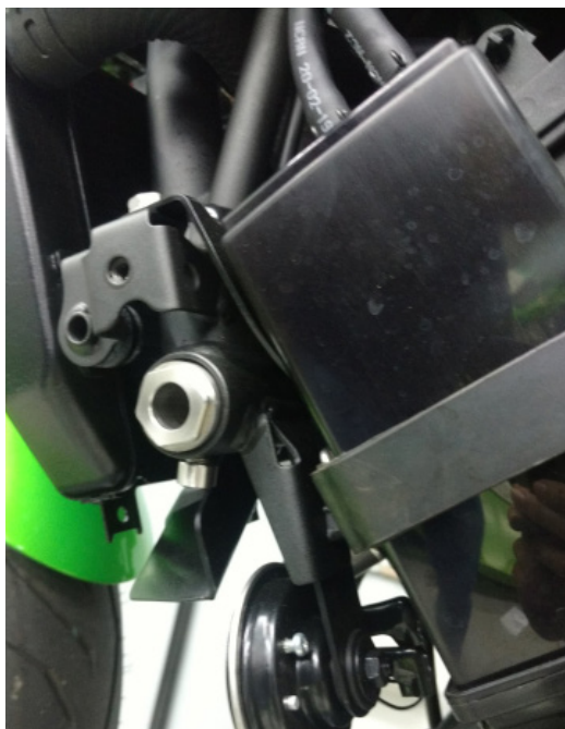
Foto 2: Parafuso de travamento deve passar pela furação no tubo do quadro
