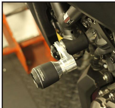
Foto 2: Foto do Slider Esquerdo instalado
