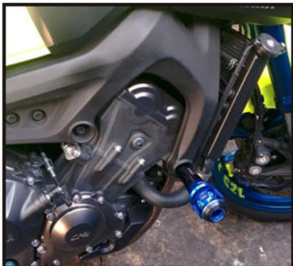
Foto 1: Foto do Slider Direito instalado
