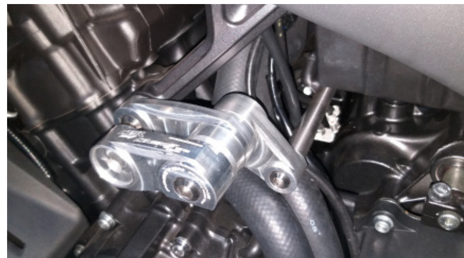
Foto 4: Extremidade esquerda da Barra de Tensão
