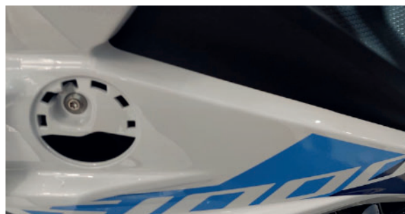
Figura 2 : Remova a tampa (logo) para ter acesso ao parafuso
