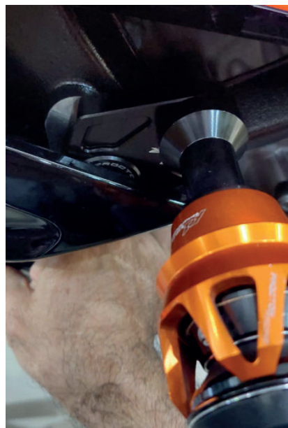
Figura 4: Suporte Instalado e carenagem encaixada
