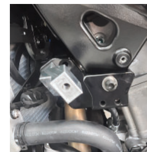
Foto 7: Suporte instalado com parafuso e bucha de acatamento
