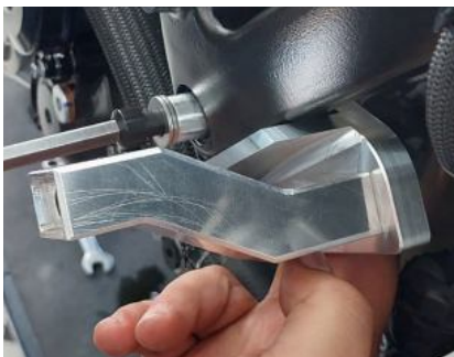
Foto 4: Acomode o suporte e parafuso junto a furação do quadro
