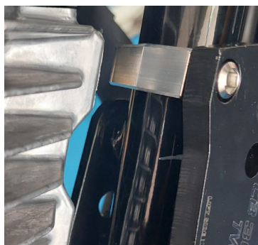
Foto 2: posição e instalação das abraçadeiras de alumínio
