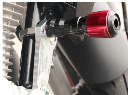
Foto 03: Slider instalado no Lado Direito
