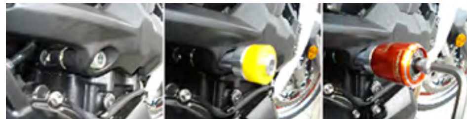
Foto 1: Sequencia de montagem Slider Direito
