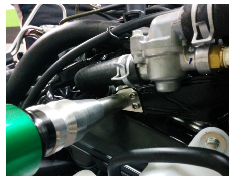
Foto 6: Suporte e Slider instalado no lado direito
