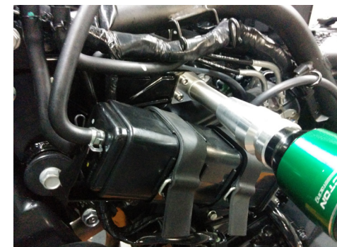
Foto 7: Suporte e Slider instalado no lado esquerdo
