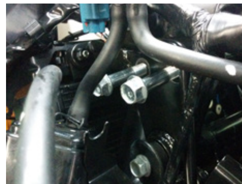
Foto 1: Retire os parafusos originais
