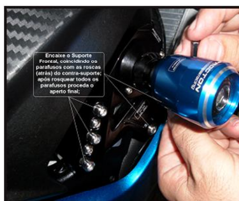
Foto 2: Encaixe o Suporte frontal
