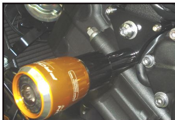
Foto 2: Slider Esquerdo parafuso M10x70 e bucha alumínio 7mm
