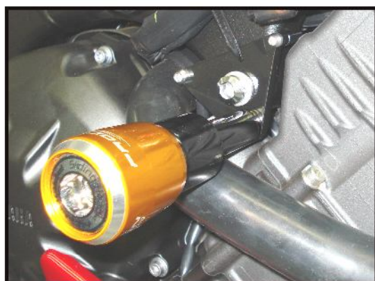
Foto 1: Slider Direito parafuso M10x60 e bucha alumínio 5mm
