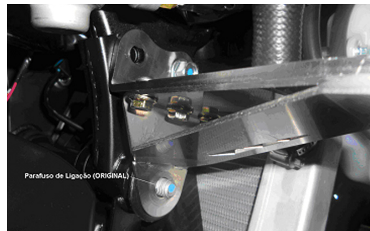
Foto 1: Instalação dos Suportes no Quadro
