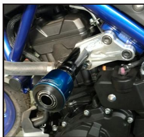
Foto 2: Foto do Slider Esquerdo instalado
