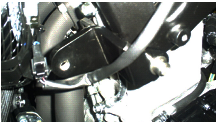
Foto 2: Acomode o suporte e parafuso junto a furação do quadro
