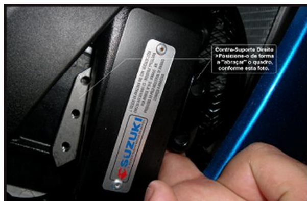
Foto 1: Posicione o Contra Suporte para "abraçar" o quadro.
