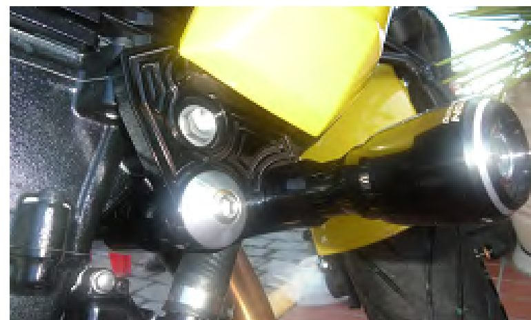
Foto 1: Retire o parafuso e instale o Suporte
