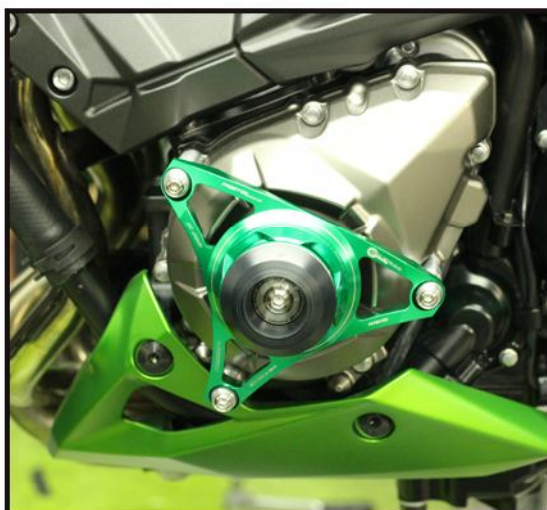
Foto 1: Pontos de fixação da estrela de motor
