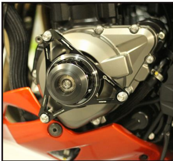
Foto 1: Pontos de fixação da estrela de motor
