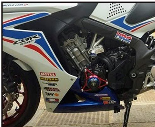
Foto 1: Pontos de fixação da estrela de motor
