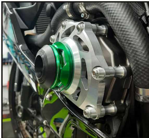
Foto 1: Pontos de fixação da estrela de motor
