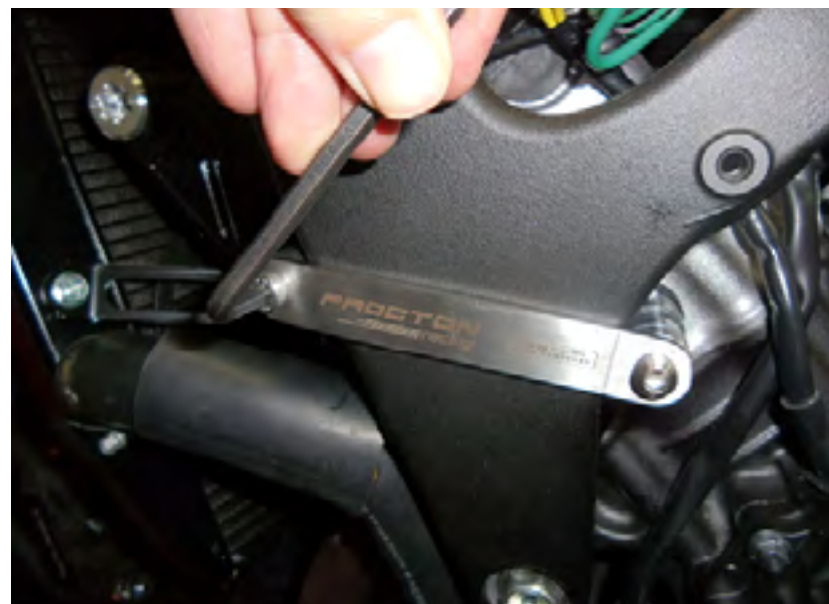
Foto 6: Rosquei a Palca Tensora no suporte
