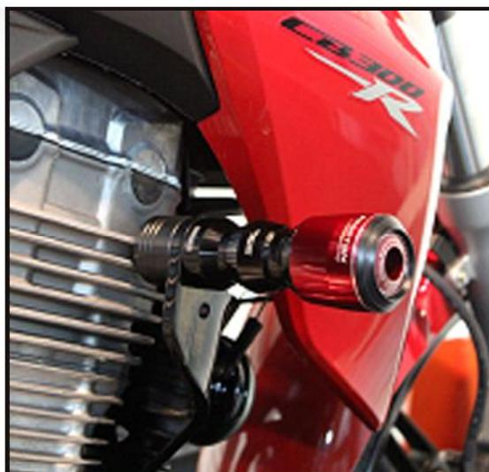
Foto 02: Slider Instalado no Lado Direito
