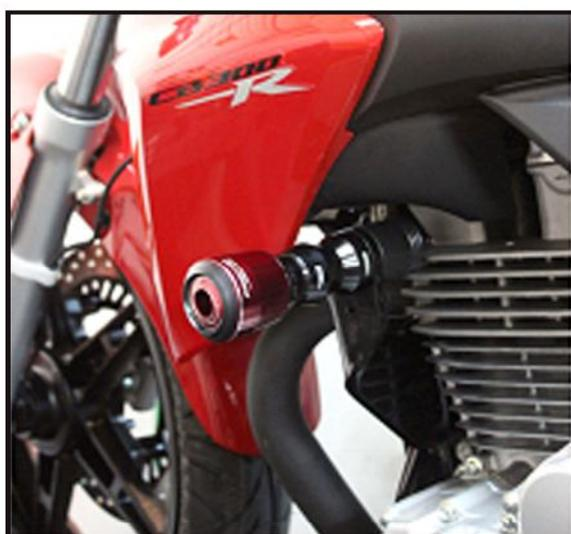
Foto 01: Slider Instalado no Lado Esquerdo
