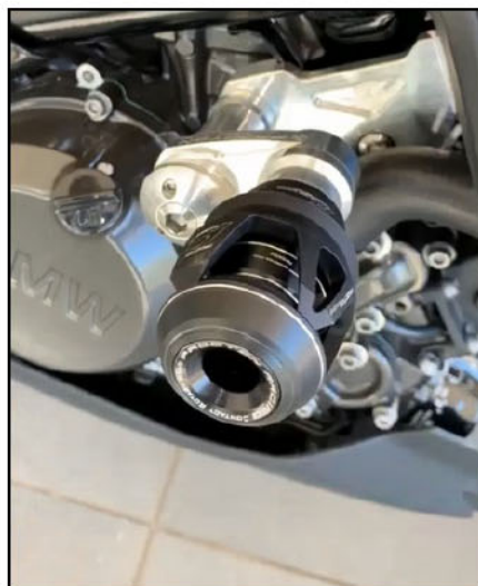
Foto 02: Slider Instalado no Lado Direito
