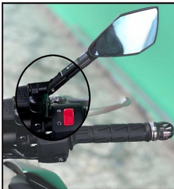
Foto 1: Pontos de fixação do retrovisor
