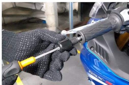
Figura 1: Use uma chave Philips ou Allen para remover o peso original.
