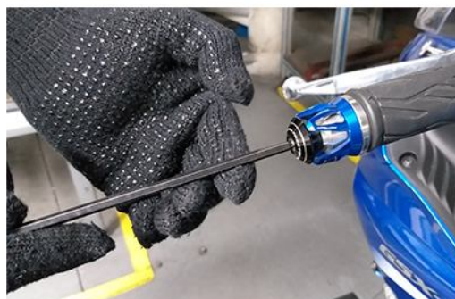
Figura 2: Utilize uma chave allen para dar o aperto no peso F1
