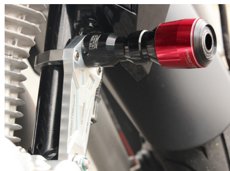
Foto 03: Slider instalado no Lado Direito
