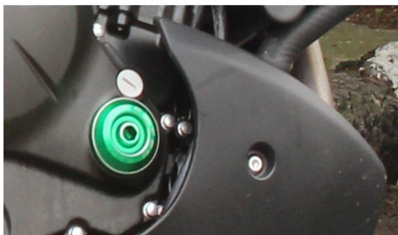
Figura : Instale o oring original na tampa de motor da Procton
