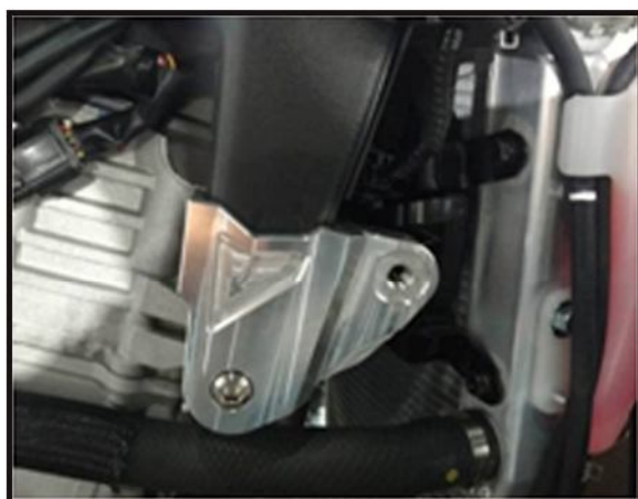
Foto 01: Slider instalado no Lado Direito
