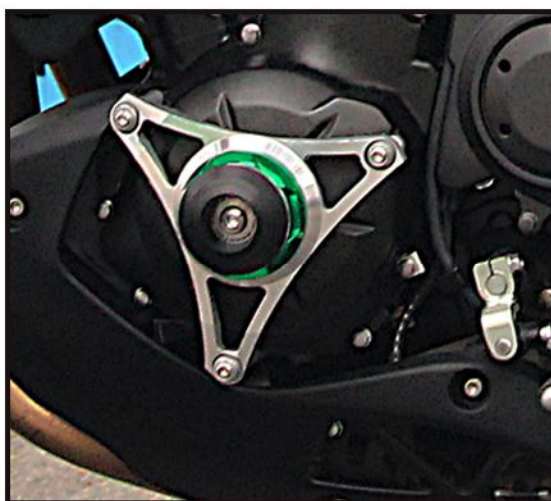
Foto 1: Pontos de fixação da estrela de motor
