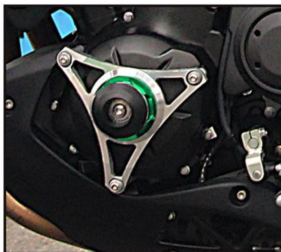
Foto 1: Pontos de fixação da estrela de motor
