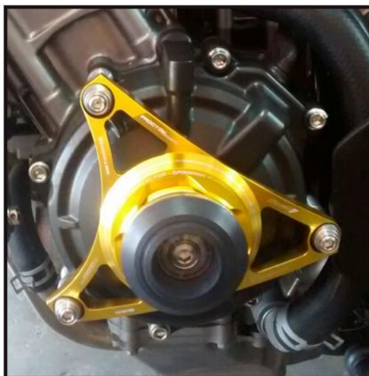
Foto 1: Pontos de fixação da estrela de motor
