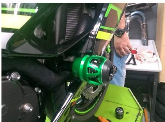
Foto 1: Ponto de instalação Lado Direito
