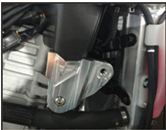
Foto 01: Slider instalado no Lado Direito
