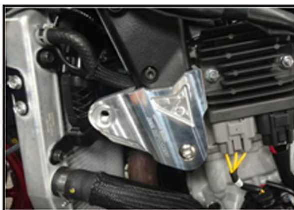
Foto 02: Slider instalado no Lado Esquerdo
