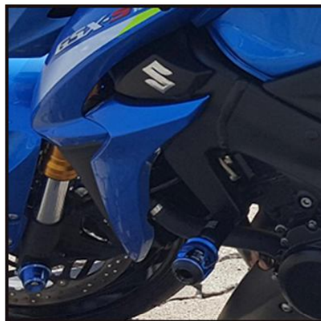
Foto 02: Slider instalado no Lado Esquerdo (maior)
