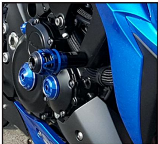
Foto 01: Slider instalado no Lado Direito (menor)
