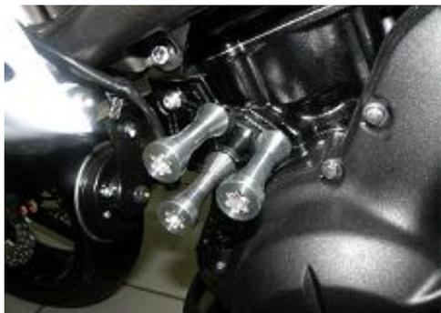
Foto 5: Slider Esquerdo fixado, observe o pino de travamento dianteiro;
