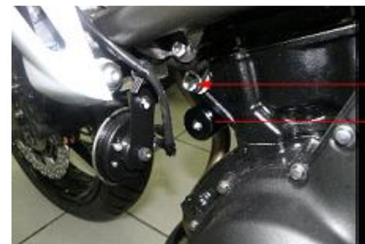
Foto 4: Ponto de encaixe e fixação dos parafusos
