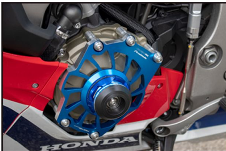
Foto 1: Pontos de fixação da estrela de motor
